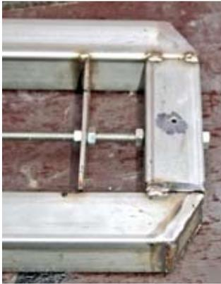
Neben ein paar Schweißpunkten müssen Pendelrohr- und Hauptrahmen komplett geschweißt werden. Wegen der Blechdicken und der Optik wird WIG-Schweißen empfohlen.
