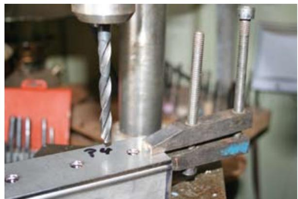
**Einige Teile sollten miteinander abgebohrt werden. Arbeitserleichternd sind eine Säulen- oder Tischbohrmaschine und Parallelschraubzwingen. Die Drehzahlen sind bei nicht rostendem Stahl eher gering zu wählen.**
