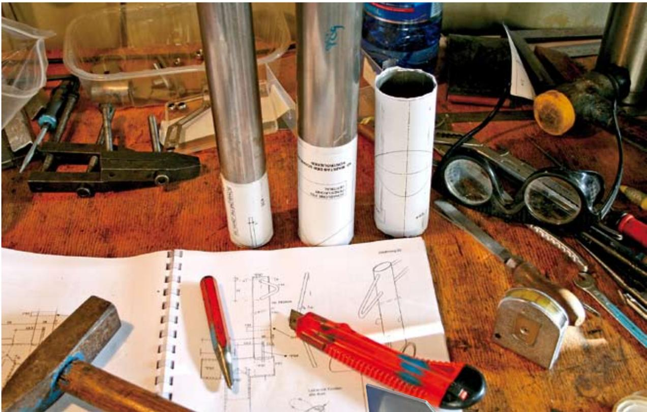
Eine wertvolle Hilfe beim Bau der Wind selbststeueranlage stellen die Schablonen dar, die als Papierschablonen aus der Bauanleitung auszuschneiden sind oder als Stahlwinkel dem Paket beiliegen. Die Papierschablonen werden mit durchsichtigem Klebeband auf den Rohren befestigt, um den Stahl entlang der aufgedruckten Schnittkanten zuzusägen.
