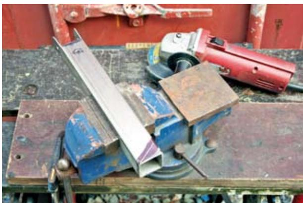
**Zunächst wird der Hauptrahmen gefertigt. Dafür werden die einzelnen Vierkantrohre abgelängt, anschließend nach Plan zugeschnitten und gebohrt. Mit einer Eisensäge oder einer schmalen Trennscheibe ist das kein Problem.**
