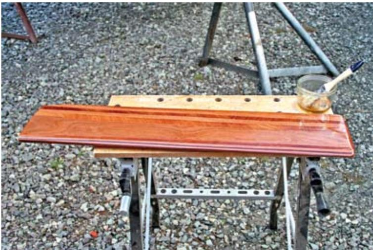
Das Pendelruderblatt besteht aus Bootsbausperholz. Um die notwendige Stärke zu erreichen, werden zunächst zwei Platten zusammengeleimt und anschließend nach den Vorgaben profiliert. Die deutlichen Grenzen der einzelnen Lagen erleichtert diese Schleifarbeiten sehr.
